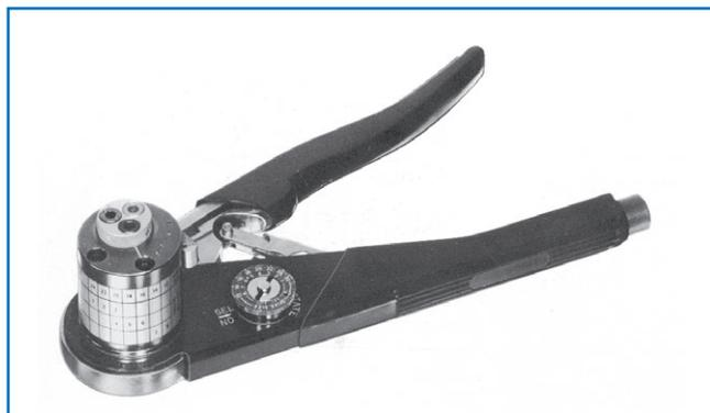
c Die Crimp-Zange M22520/1-01 (8-Kerb-Crimpverbindung) wird mit einem einzigen Crimp-Einsatz bestückt (siehe Seite 30), der das Crimpen der Kontaktgrößen 12, 16 und 20 ermöglicht. Siehe auch Bedienungsanleitung des Herstellers.
