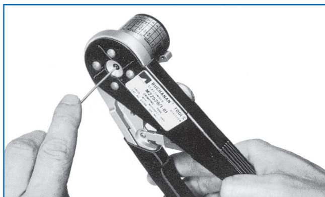
e Nach dem ordnungsgemäßen Einstellen der Drahtstärke- und Kontaktgröße die Crimp-Zange M22520/1-01 schließen und öffnen, um sicherzustellen, dass die Crimp-Backen geöffnet sind. Kontakt mit dem Leiter in die Aufnahme einsetzen. Zange schließen, bis sie automatisch öffnet. Kontakt aus der Aufnahme nehmen und prüfen, ob der Leiter im Prüfloch des Kontakts sichtbar ist.
