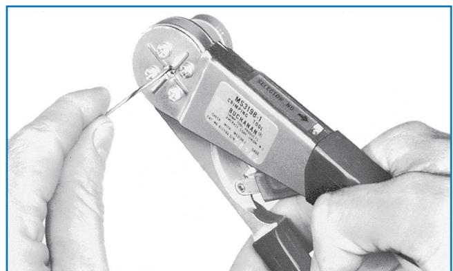
f Nach dem Auswählen des entsprechenden Crimp-Einsatzes die Crimp-Zange M22520/2-01 bzw. MS 3198-1 schließen und öffnen, um sicherzustellen, dass die Crimp-Backen geöffnet sind. Kontakt mit Leiter in die Aufnahme einsetzen. Zange ganz schließen, bis sie automatisch öffnet. Kontakt aus der Aufnahme nehmen und prüfen, ob der Leiter im Prüfloch des Kontakts sichtbar ist.
