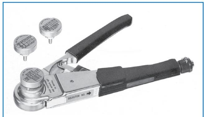
d Für die Crimp-Zange M22520/2-01 bzw. MS 3198-1 (8-Kerb-Crimpverbindung) stehen 3 Crimp-Einsätze (siehe Seite 30) zur Verfügung, die das Crimpen der Kontaktgrößen 22 und 22 D erlauben. Siehe auch Bedienungsanleitung des Herstellers.
