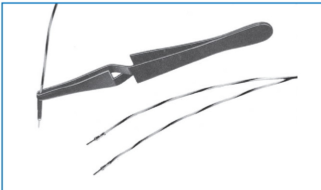
c Spitze des Einsetzwerkzeugs bis zur Kontaktschulter über den Leiter führen.
